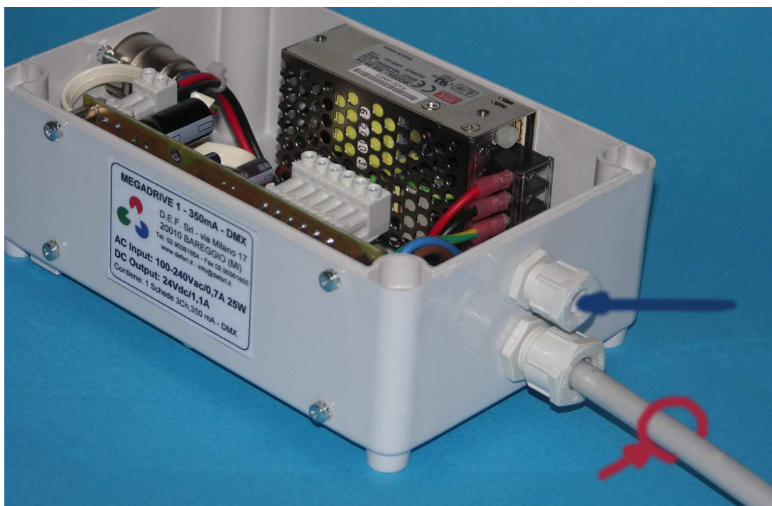
Cavo alimentazione quadro e PG7 connessione LED
